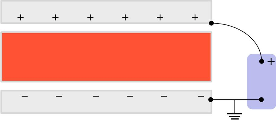
1. Der Kondensator wird auf 25 kV aufgeladen, die untere Platte ist geerdet, auf dem Dielektrikum befinden sich keine zusätzlichen Ladungen.
