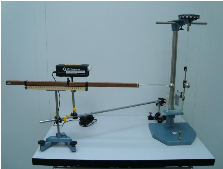
Moderner Aufbau zur Bestimmung des Coulombgesetzes
