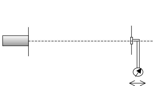
Abb. 5.4: Schema des experimentellen Aufbaus mit dem Sender links und der Metallwand rechts. Dazwischen der Empfangsdipol mit angeschlossnem Stromstärke-Messinstrument.
