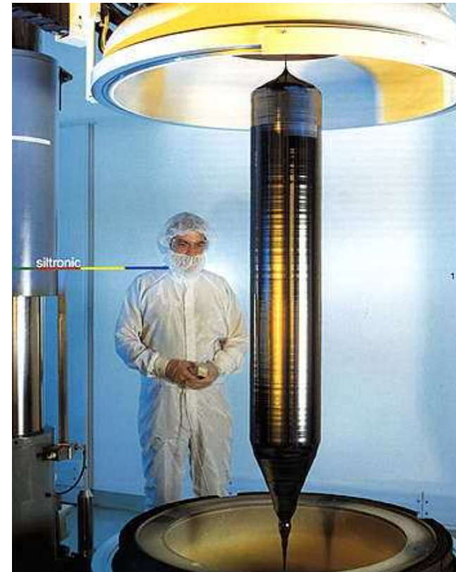
Abb.2: Fertiger Si-Einkristall nach Czochralski
